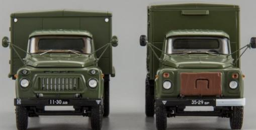
**На этих фото хорошо видна разная форма смонтированных фургонов.**
