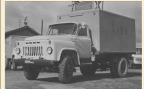
Выпуск специализированных фургонов ГЗСА-3704 (грузоподъемностью 2170 кг) для перевозки хлебобулочных изделий (на шасси ГАЗ-52-01) был освоен Горьковским заводом специализированных автомобилей в 1967 г.
