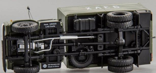
Версия **105325** (1986 год), при всей похожести, стоит особняком: картер V-образного двигателя, «сдвоенная» система выпуска выхлопных газов, которая сходится в один «глушитель», два вакуумных усилителя тормозов, слева на раме – дополнительный бак на 105 л, в задней части рамы – специальное оборудование, в виде пары ящиков, «треугольные» диски и соответствующая резина. Задний мост – «банджо». Все как у настоящей.
