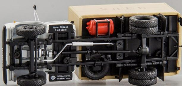
Выхлопная система слегка модернизирована: выхлоп направлен не в сторону, а вниз.
