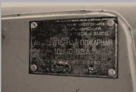
Не смотря на смены шасси, (независимо, будь то ГАЗ-53А, ГАЗ-53-12, или даже ГАЗ-3307) автомобиль имел маркировку АЦУ-10(53А) (ТУ 70 УССР 1801.218-80) и только в 1988 году появилась маркировка АЦУ-10(3307) (ТУ 10.19 УССР 22-88)
