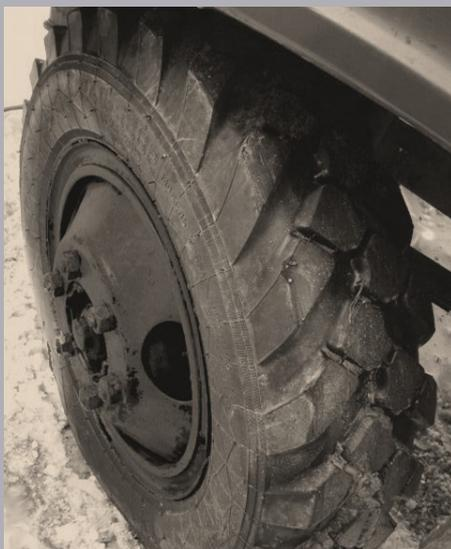
Часть автомобилей с завода комплектовалась «вездеходными» шинами К-10 (К-55а) с протектором «ломаная ёлка», что значительно улучшало проходимость моноприводного грузовика на плохих дорогах.
